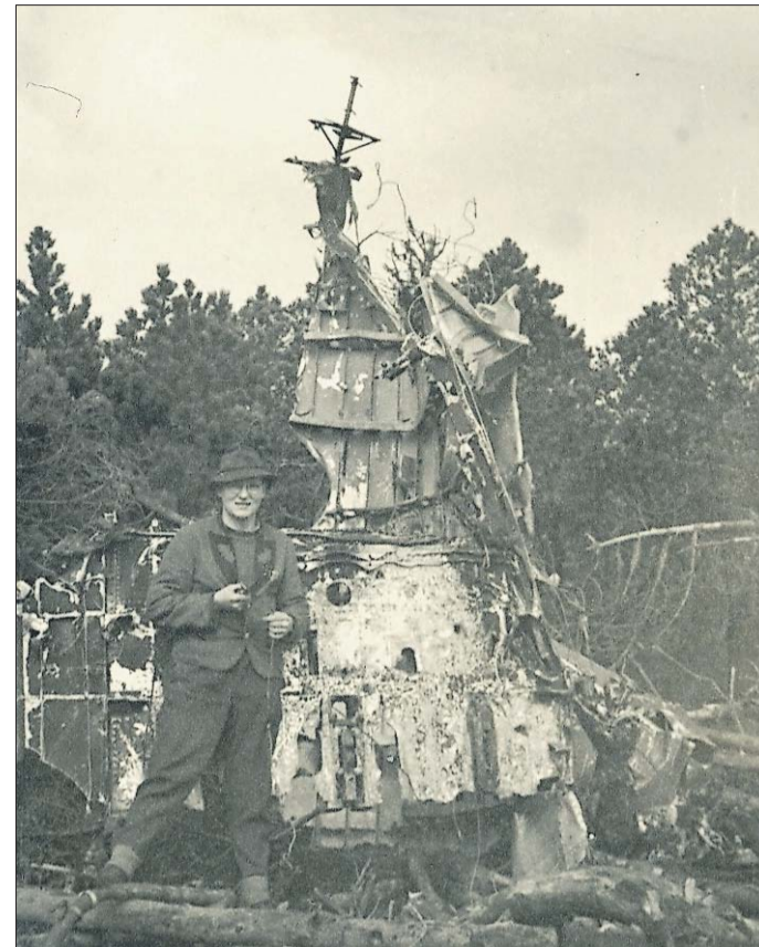
Überreste eines Rolls-Royce-Reihenkolbenmotors (1500 PS) der im Wildseemoor zerschellten Lancaster, aufgenommen im April 1947. Foto: Archiv Zapf
